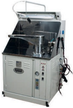
KENDİNDEN KAZANLI LEKE ÇIKARTMA MAKİNASI SPOT REMOVING MACHINE WITHIN BOILER ПЯТНОВЫВОДНОЙ СТОЛ СО ВСТРОЕННЫМ БОЙЛЕРОМ
